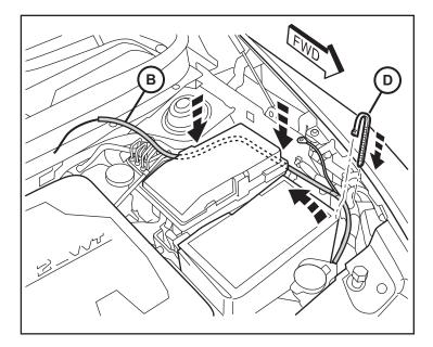
8. En el borde exterior próximo a la batería, retire la suelo existente tuerca para cable. Coloque el suelo anillo terminal del arnés principal (B) y vuelva a colocar la tuerca para fijarlo.
