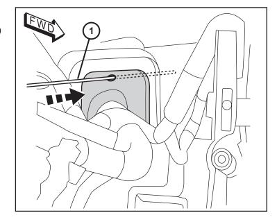
13. Asegure el extremo del mazo de cables al alambre de metal de largo con un trozo de cinta. Tire del extremo del arnés (B) a través de la parte interior debajo del tablero. Aplicar RTV sellador en el cableado y tire de los cables en el tubo para sellar el cableado en el tubo.
