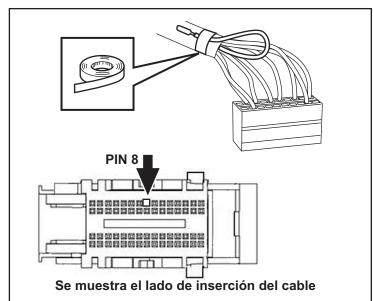
17. Inserte el conector de cable con lengüetas del mazo del interruptor (B) en la clavija 8 del conector.
