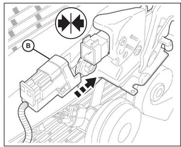
6. Desprenda con cuidado el panel de cubierta del radiador. Encause el mazo del interruptor (B) hacia el lado del conductor junto con el arnés del vehículo existente. Alimente el cableado del interruptor bajo las mangueras y soportes como se muestra. Asegure con ataduras de cables (D).
