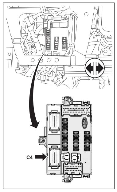
15. Separe del BCM el enchufe del conector superior izquierdo. Oprima las lengüetas de liberación en la parte trasera del conector y deslice el enchufe hacia afuera de la funda exterior.
