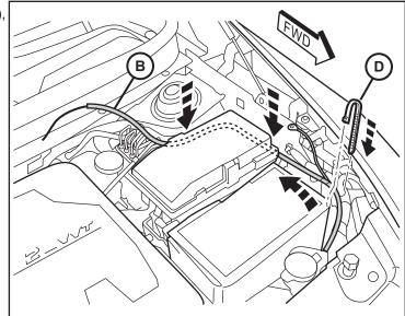
Le long du bord extérieur à côté de la batterie, retirez la existant écrou fil de terre. Placer la cosse de masse (B) du faisceau de câbles principal en position et refixer l'écrou.
