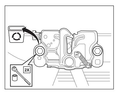
Desprenda con cuidado el panel de cubierta del radiador. Desconecte y retire el cable de liberación del pestillo del capó. Quite el conjunto del pestillo del capó.
