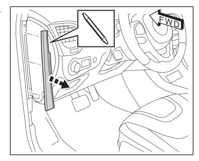
Retire con cuidado el panel de ajuste al final de la salpicadero en el lado del conductor. Quite dos (2) tornillos y dos (2) clips del panel de moldura inferior. Retire con cuidado el panel inferior bajo la columna de dirección. Tire del arnés (B) hasta el interior.
