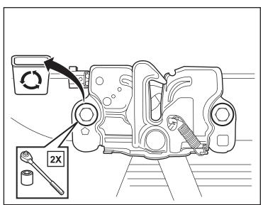
3. Soulevez délicatement le panneau recouvrant le radiateur. Débrancher et déposer le câble de déverrouillage du capot. Déposez l'ensemble de verrouillage du capot.
