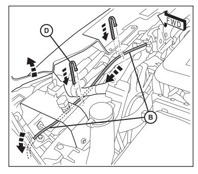
7. Encause el mazo del interruptor (B) junto con los mazos existentes en el vehículo sobre el lado del conductor y de regreso hacia la parte trasera del compartimiento del motor. Coloque el arnés detrás de la caja de fusibles, como se muestra. Asegure con ataduras de cables (D).
