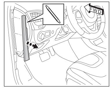
10. À l'aide de l'outil pour garnitures, déposez le capuchon d'embout du tableau du côté conducteur. Retirez les deux (2) vis et les deux (2) clips du panneau de garniture inférieur. Retirez le panneau de garniture inférieure sous la colonne de direction. Tirez le commutateur Harnais (B) à travers le plancher à l'intérieur.
