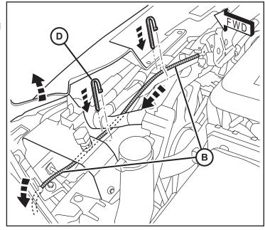
7. Faites passer le faisceau de câbles du commutateur (B), le long des faisceaux existants du véhicule vers le côté conducteur et puis vers l'arrière du compartiment moteur. Route fil derrière la boîte à fusibles. Fixez avec des attaches de câble (D).
