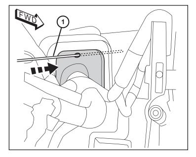
13. Fixer l'extrémité du fil (B) à la tige métallique avec un morceau de ruban adhésif. Tirer le faisceau de câbles par l'intermédiaire de l'intérieur du véhicule, sous le tableau de bord. Appliquer du RTV mastic pour le câblage électrique et tirez sur le faisceau de câbles dans le tube à sceller.
