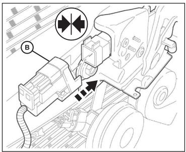
6. Soulevez délicatement le panneau recouvrant le radiateur. Acheminez le faisceau de câbles du commutateur (B) le long du faisceau de câbles principal du véhicule, en direction du côté du conducteur. Nourrir le harnais dans les tuyaux comme indiqué. Fixez avec des attaches de câble (D).
