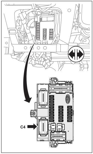
15. Isolez la prise supérieure gauche du module BCM. Appuyez sur les languettes de dégagement à l'arrière du connecteur et glissez le connecteur hors de la coquille.
