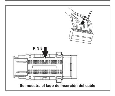
18. Vuelva a instalar la funda exterior sobre el conector. Enchufe todos los conectores al BCM.
