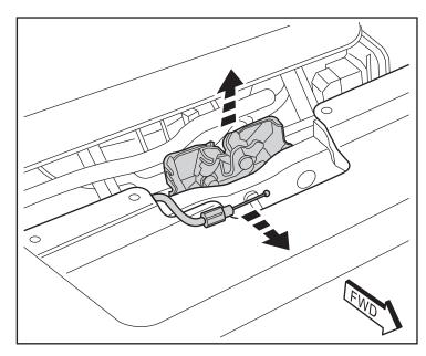
4. Vuelva a conectar el cable de liberación del pestillo del capó a la parte trasera del conjunto de pestillo nuevo del capó. Ponga el pestillo nuevo (A) sobre las marcas de alineación y sujételo con dos (2) pernos hexagonales. Apriete los pernos a 11 Nm (8 pìes-lb).
