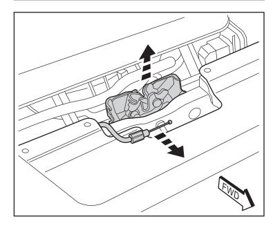
4. Rebranchez le câble de déverrouillage du capot à l'arrière du nouvel ensemble de verrouillage. Alignez le nouveau verrou de capot (A) sur les marques d'alignement et fixez-le avec deux (2) boulons hexagonaux. Serrez les boulons au couple de 11 N-m (8 lb-pi).
