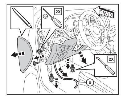
Retire tres (3) sujetadores del conjunto de la palanca de liberación de la campana. Desconecte el conector OBD y baje el conjunto debajo del tablero de instrumentos.
