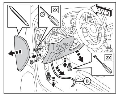
Retirez les trois (3) fixations de l'assemblage du levier de déverrouillage de la hotte. Débranchez le connecteur OBD et abaissez l'ensemble sous le tableau de bord.
